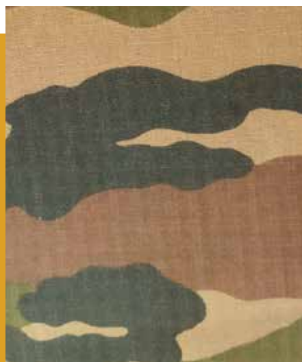
Tissu pour l'armée française avec impression « camouflage » au cylindre rotatif. Tissu non feu et thermostable, traité déperlant et anti-moustique. Europrotect France
